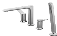
FB D0748D 8" 욕조 수전 (시공hole : 양쪽핸들 Ø 32~35, 토수구 Ø 26~30, 샤워헤드 Ø 29~32) 좌측 : 온수 우측 : 냉수
